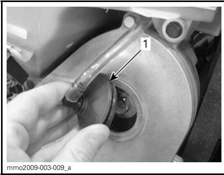
1. Bouchon de remplissage
