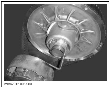
VARIAATTORIN AVAUSTYÖKALU ASENNETTUNA SÄÄTIMEN NAPAAN
