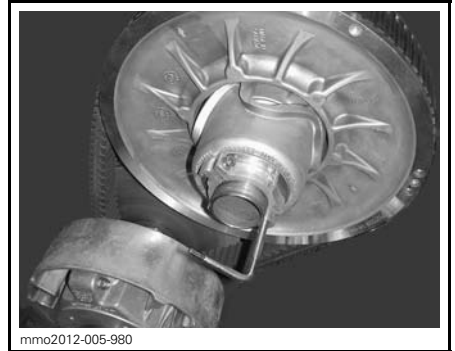
VARIAATTORIN AVAUSTYÖKALU ALUMIINISEN SÄÄTIMEN NAVASSA
