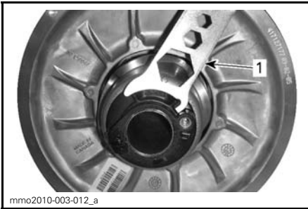
MUOVINEN SÄÄTIMEN NAPA 1. Jousituksen säätötyökalu
