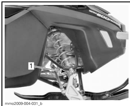
ESIMERKKI - SÄÄTÖNOKKATYYPPINEN ESIJÄNNITYS 1. Säätönokka
