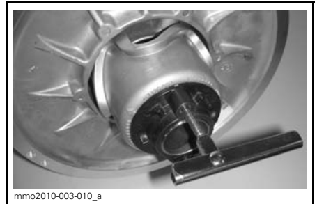
VARIAATTORIN AVAUSTYÖKALU MUOVISEN SÄÄTIMEN NAVASSA
