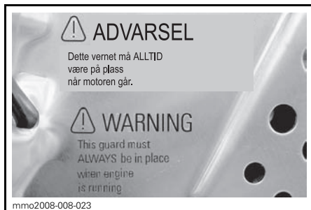
DEKAL 18 – PÅ BREMSEKIVEVERN (BART METALL PÅ TUNNEL)
