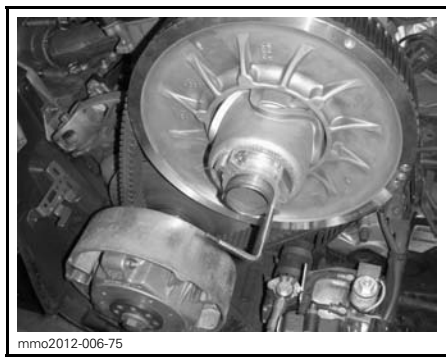
VARIATORNS UTVIDGARE INSTALLERAD PÅ JUSTERINGSNAVET
