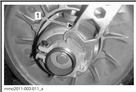
TYPBILD - PRELIMINÄR INSTÄLLNING 1. Kuggarnas dalar i nivå med sekundärvariatorns kanter
