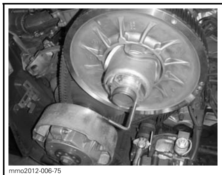
FORLENGER FOR DRIVREIM MONTERT PÅ JUSTERINGSNAV
