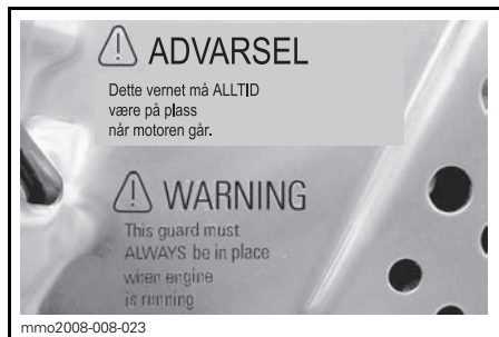
mmo2008-008-023 DEKAL 14 – PÅ BREMSEKIVEVERN (BART METALL PÅ TUNNEL)
