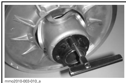
VARIATORNS UTVIDGARE INSTALLERAD PÅ JUSTERINGSNAV I PLAST
