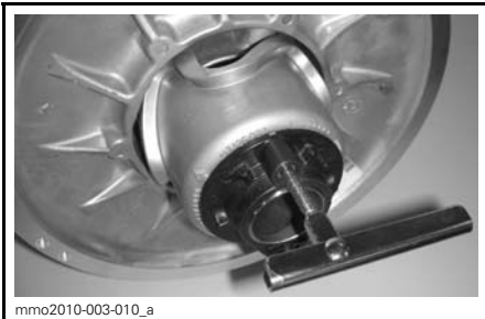
VARIATORNS UTVIDGARE INSTALLERAD PÅ JUSTERINGSNAV I PLAST
