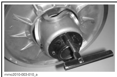
mmo2010-003-010_a MANDRIN DE POULIE MENÉE SUR UN DISPOSITIF DE RÉGLAGE EN PLASTIQUE
