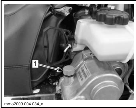
1. Bouchon de remplissage
