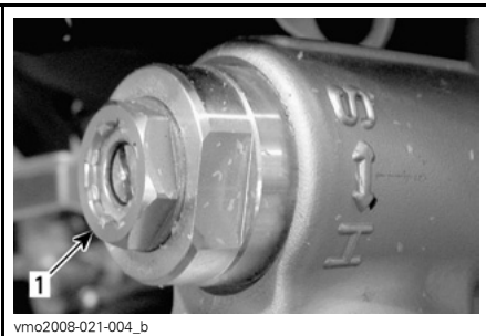
TYPISCH — ENKEL X XC PACKAGE 1. Compressieregelaar hoge snelheid (sleutel van 17 mm)
