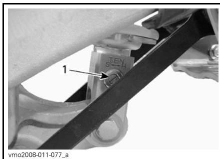
1. Regelaar terugvering (platte schroevendraaier)
