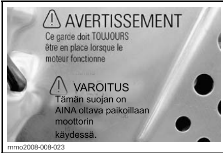
JARRULEVYN SUOJASSA (PELKKÄ METALLITUNNELI)
