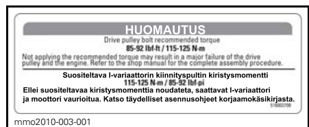
KILPI 6 – VARIATTORIHIHNNAN SUOJASSA
