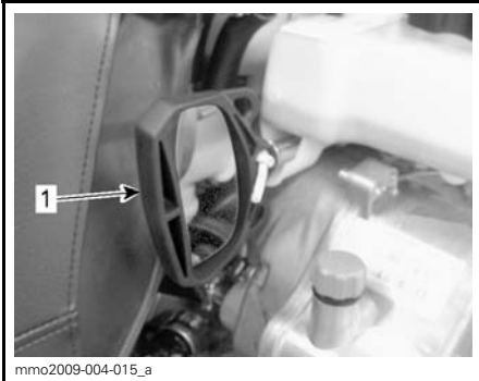
1. Håndtak for tilbakespolingsstarter
