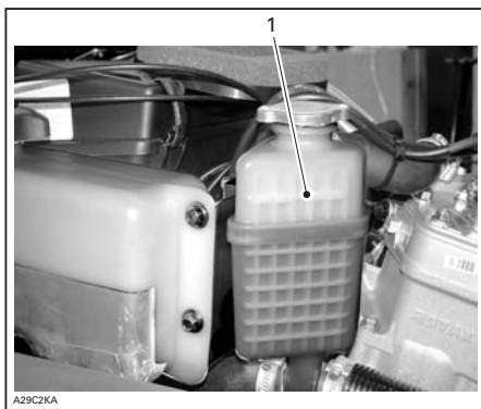
MOTEUR 600 TYPIQUE 1. Ligne NIVEAU FROID
