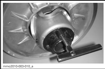
JUSTERING AV REIMSKIVE - RINGJUSTERING
