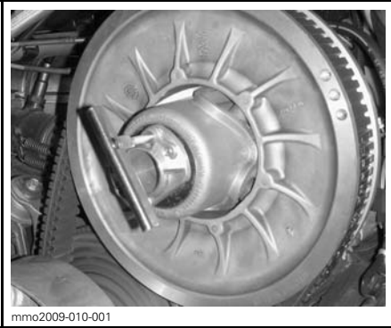
JUSTERING AV REIMSKIVE - SKRUEJUSTERING
