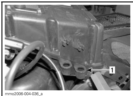
mmo2006-004-036_a TÄNDSTIFTSHÅLLARE PÅ LJUDDÅMPAREN FÖR LUFTINTAG (KAROSSIDAN) 1. Behållare för reservtändstift
