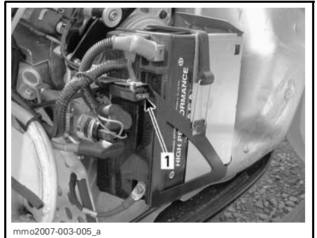
SUPPORT DE BATTERIE 1. Fusible du circuit de charge
