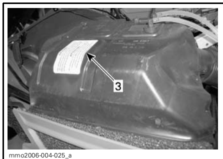
SILENCIEUX D'ADMISSION D'AIR (CÔTÉ CARROSSERIE) — MOTEUR 2-TEMPS
