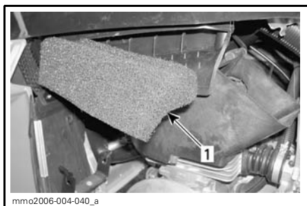
CÔTÉ GAUCHE — EMBLACEMENT DU FILTRE À AIR
