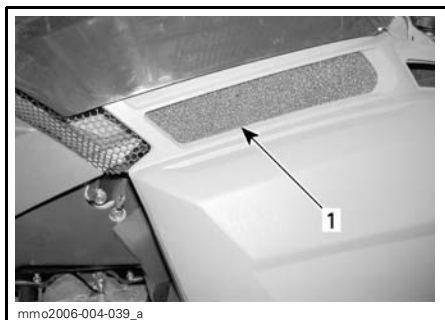
CÔTÉ GAUCHE — EMBLACEMENT DU FILTRE À AIR
