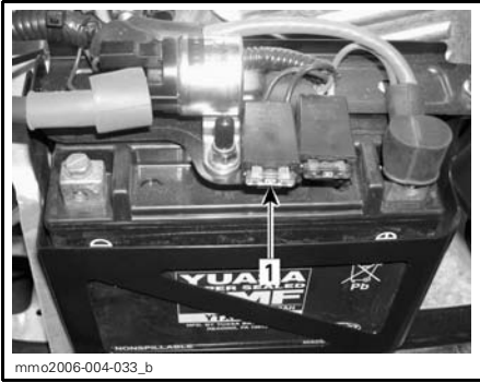
MODÈLES À DÉMARRAGE ÉLECTRIQUE 1. Fusible de protection de masse
