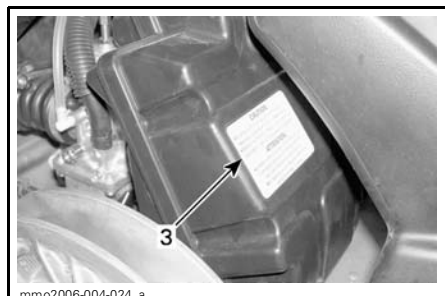
SILENCIEUX D'ADMISSION D'AIR (CÔTÉ MOTEUR) — MOTEUR 2-TEMPS
