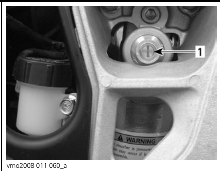
1. Regulador da compressão (chave de parafusos de lâmina chata)
