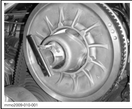
MANDRIN INSTALLÉ SUR UNE POULIE MENÉE AVEC DISPOSITIF DE RÉGLAGE À VIS
