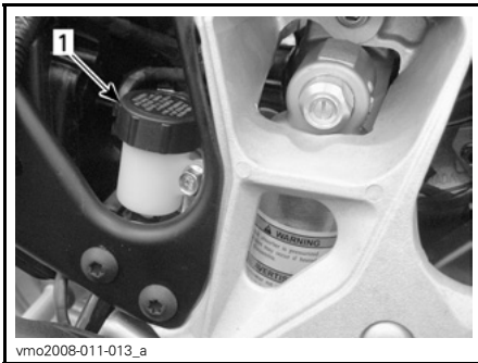
DIT BEVINDT ZICH NAAST HET RECHTERACHTERSPATBORD. 1. Achterrem-vloeistofreservoir
