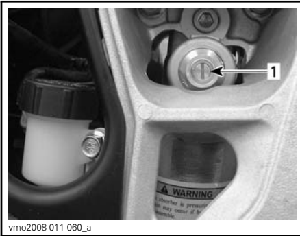
1. Dispositif de réglage de la compression (tournevis à lame plate)
