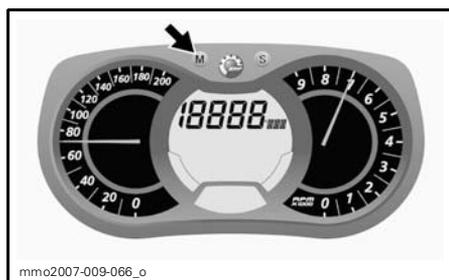
Pour remettre à zéro, appuyer sur le bouton de mode (M) pour sélectionner le mode.
