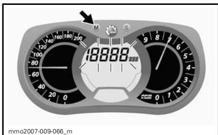
Appuyer sur le bouton de réglage (S) et le tenir dans les 5 prochaines secondes pour remettre à zéro.
