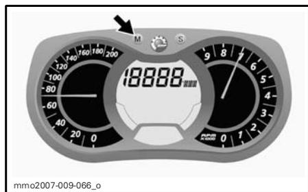
Pour remettre à zéro la température maximale enregistrée, appuyer sur le bouton de mode (M) pour sélectionner le mode.
