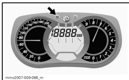
Appuyer sur le bouton de réglage (S) et le tenir dans les 5 prochaines secondes pour remettre à zéro.
