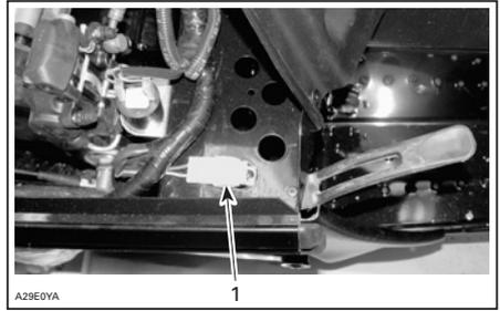
FUSIBLE DU SYSTÈME DE DÉMARRAGE ÉLECTRIQUE ET PRISE DE COURANT — SKANDIC WT 600/SUV
