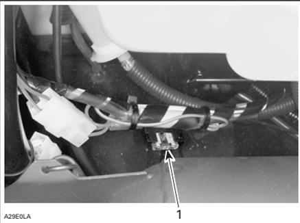
FUSIBLE DU SYSTÈME DE DÉMARRAGE ÉLECTRIQUE ET DE LA PRISE DE COURANT — SKANDIC LT E/WT 550/SWT
