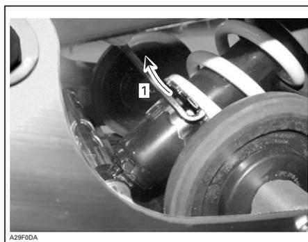
1. Utiliser la clé de réglage fournie dans la boîte d'outils pour augmenter la précharge
