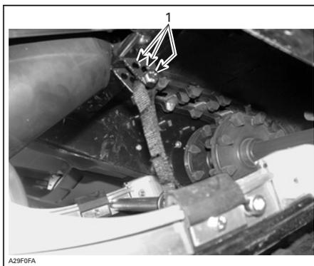
1. Boulonner la courroie d'arrêt dans un autre orifice
