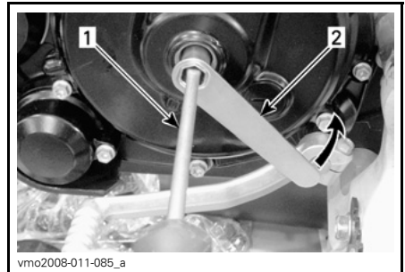
1. Schroevendraaier 2. Afstelsleutel voor de koppeling
