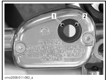
vmo2008-011-062_a TYPISCH 1. Correct vloeistofpeil 2. Laag vloeistofpeil
