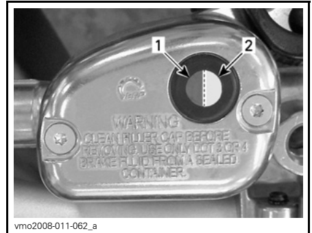
TÍPICO 1. Nivel de líquido correcto 2. Nivel de líquido bajo
