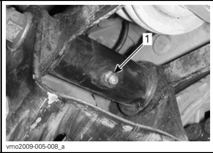
BRAZO PIVOTANTE 1. Engrasador
