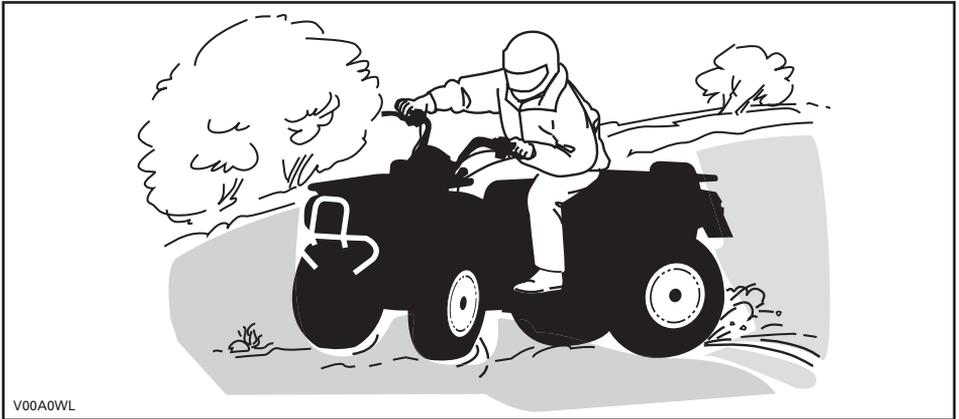
Se deslizar ou derrapar, vire o guidão na direção de derrapagem até recuperar o controle do veículo. Nunca pise fundo no freio nem bloqueie as rodas.
