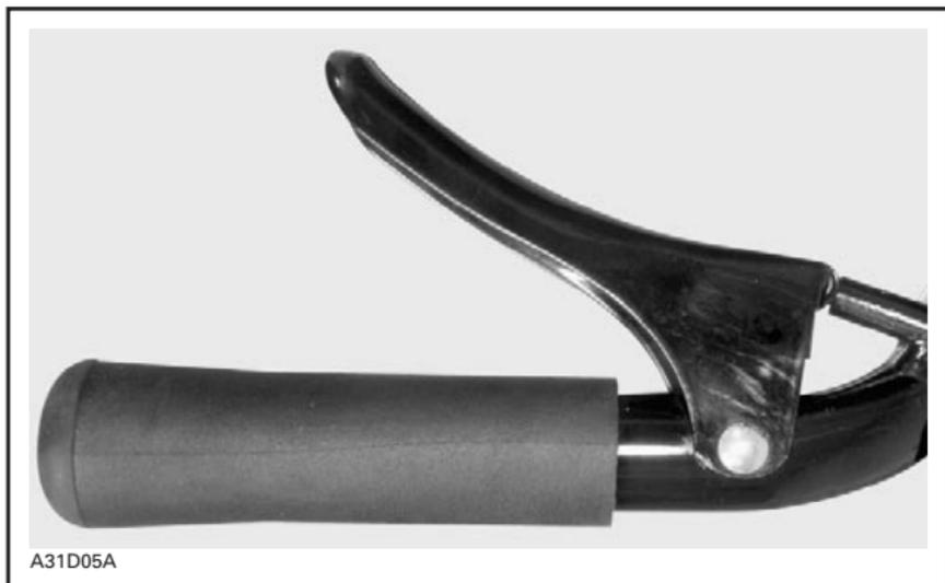
*CORRECT BRAKE LEVER POSITION BEFORE STARTING*
