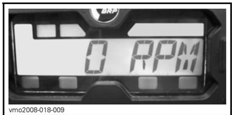
3. Premere il selettore e TENERE PREMUTO per 2 secondi. In questo modo la modalità passerà da tachimetro a giri/min (RPM) o combinata
