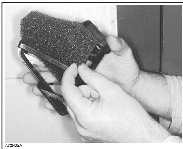
DÉPOSE DU FILTRE PRIMAIRE DE SA GRILLE
