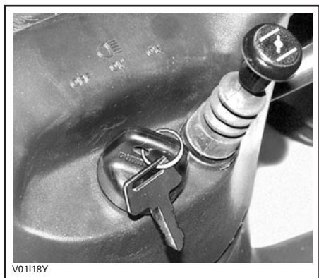
LEVIER D'ÉTRANGLEUR EN POSITION «FULL CHOKE»
