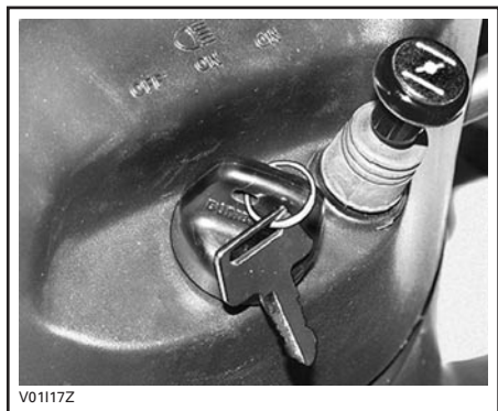
LEVIER D'ÉTRANGLEUR EN POSITION «OFF»
