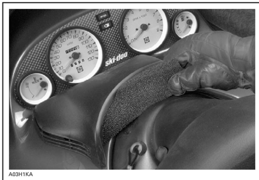
**TYPIQUE — DÉPOSE DU FILTRE**
