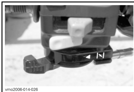
TYPEBILDE – CHOKESPAK I POSISJONEN FOR FULL CHOKE
