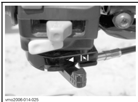
TYYPILLINEN — RIKASTINVIPU POIS-ASENNOSSA.
