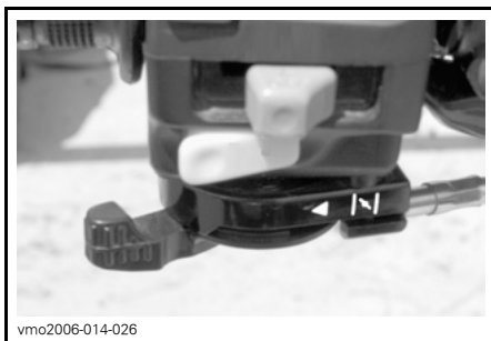
TYYPILLINEN — RIKASTINVIPU TÄYSIN PÄÄLLÄ -ASENNOSSA.
