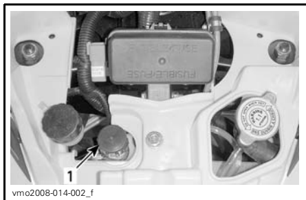
1. Réservoir de liquide de refroidissement
