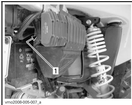
TYPBILD — SÄKRINGARNAS PLATS BAKTILL 1. Säkringshållare
