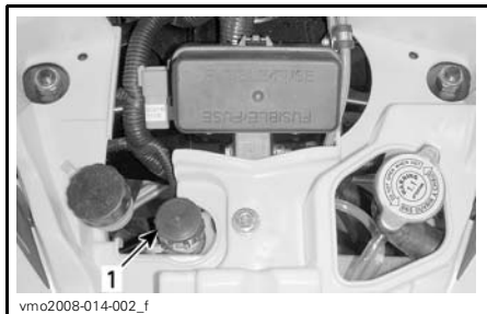
1. Réservoir de liquide de refroidissement
