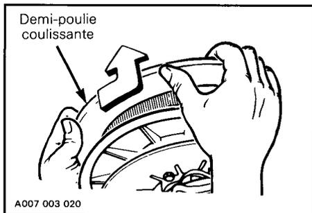
7. Glisser la courroie par-dessus le rebord supérieur de la demi-poulie coulissante conformément à l'illustration suivante.
