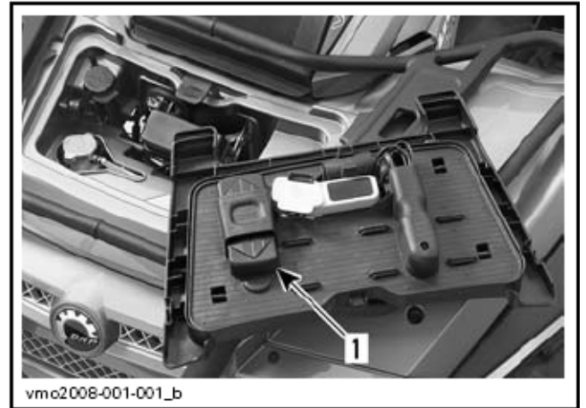
检修窗板 – 前检修室
