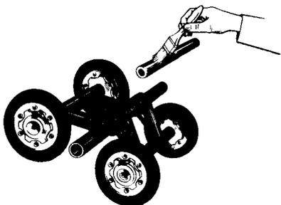
Graisser chaque roue et vaporiser un enduit protecteur sur les ressorts. À défaut, les essuyer avec un chiffon imbibé d'huile. Remonter les bogies et les remettre en place.
