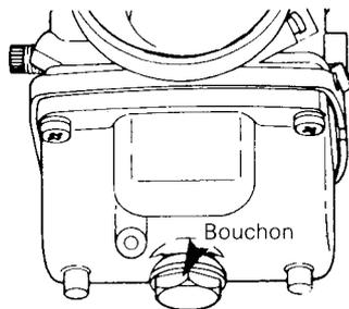
Remettre le bouchon et brancher le conduit d'alimentation.
