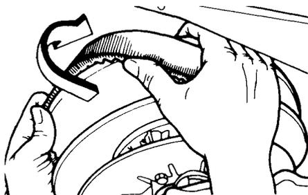
4. Faire glisser la courroie par-dessus la poulie motrice et la retirer du véhicule. Faire l'inverse pour reposer la courroie.
