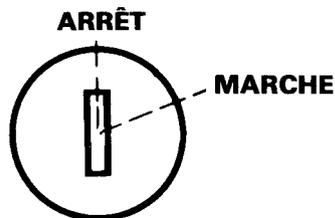
Commutateur à 2 positions (MARCHE/ARRÊT). Pour faire démarrer le moteur, tourner la clé vers la droite (position MARCHE); pour l'arrêter, tourner vers la gauche (position ARRÊT).
