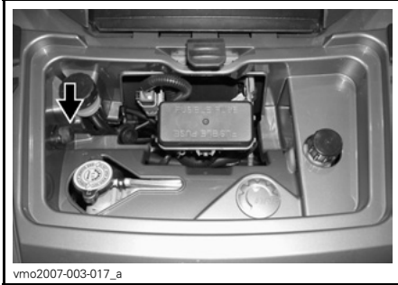
TYPEBILDE – SERVICEROM FORAN 1. Tilkobling for fjernkontroll
