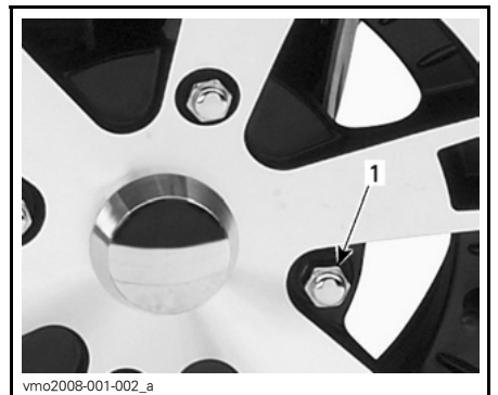
TYPISCH — TYPE MET GESLOTEN UITEINDE 1. Wielmoer
