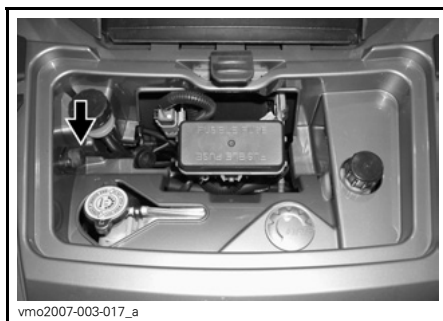
TYPISCH — VORDERES SERVICEFACH 1. Anschluss für Fernsteuerung
