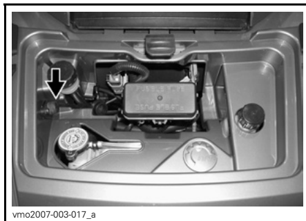
TYPISCH — VORDERES SERVICEFACH 1. Anschluss für Fernsteuerung
