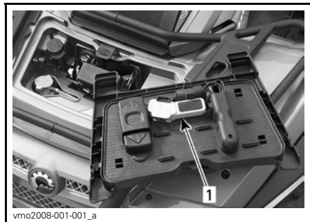
TYPISCH — VORDERE FAHRZEUGVERKLEIDUNG. 1. Winden-Fernsteuerung
