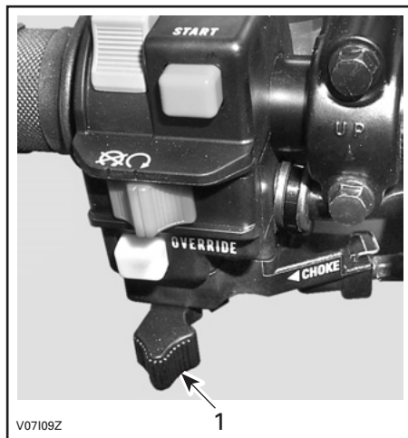
TYPBILD 1. Choke i helöppet läge
