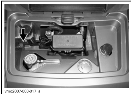
TYPEBILDE – SERVICEROM FORAN 1. Tilkobling for fjernkontroll
