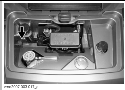
TYPISCH — SERVICECOMPARTIMENT VOORAAN 1. Aansluiting afstandsbediening
