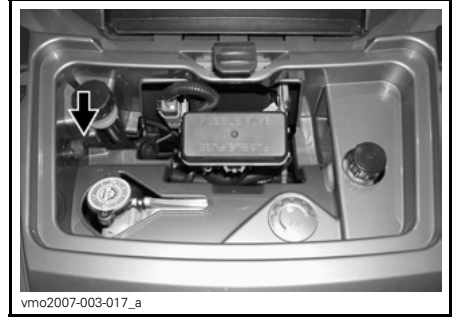
TYPISCH — SERVICECOMPARTIMENT VOORAAN 1. Aansluiting afstandsbediening
