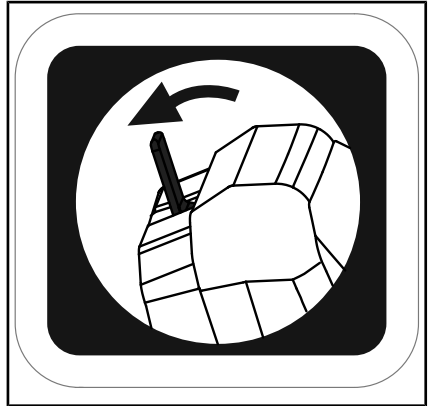
LASKE KESKI-ISTUIN VETÄMÄLLÄ KIELEKETTÄ
