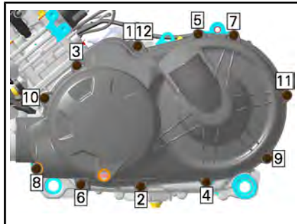
HD5 - CVT:N (PORTAATON VOIMANSIIRTO) KANNEN KIRISTÄMISJÄRJESTYS
