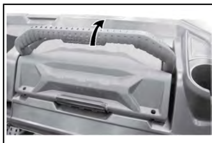
DE GEREEDSCHAPSKIST OP ZIJN PLAATS BEVESTIGEN
