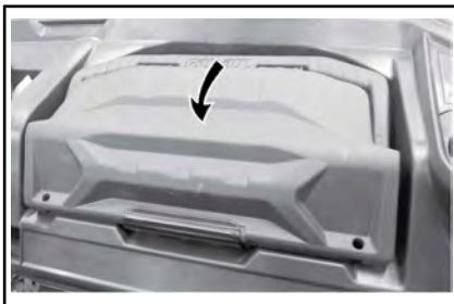
DE AFNEEMBARE GEREEDSCHAPSKIST ONTGRENDELEN
