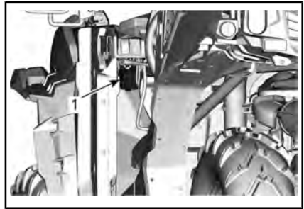
1. Передний блок предохранителей
