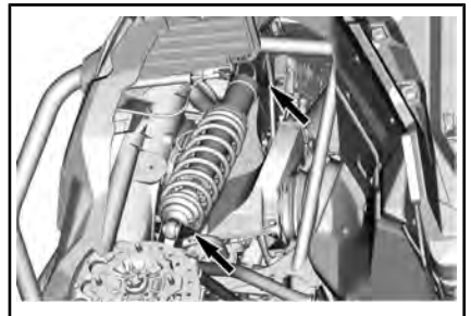
PARTIES ENLEVÉES POUR PLUS DE CLARTÉ : FIXATIONS DES AMORTISSEURS AVANT
